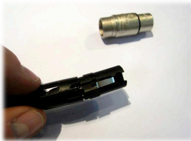
Quand vous placez la bague de serrage, veillez à ce qu'elle repose sur le câble et non sur les 3 conducteurs.
